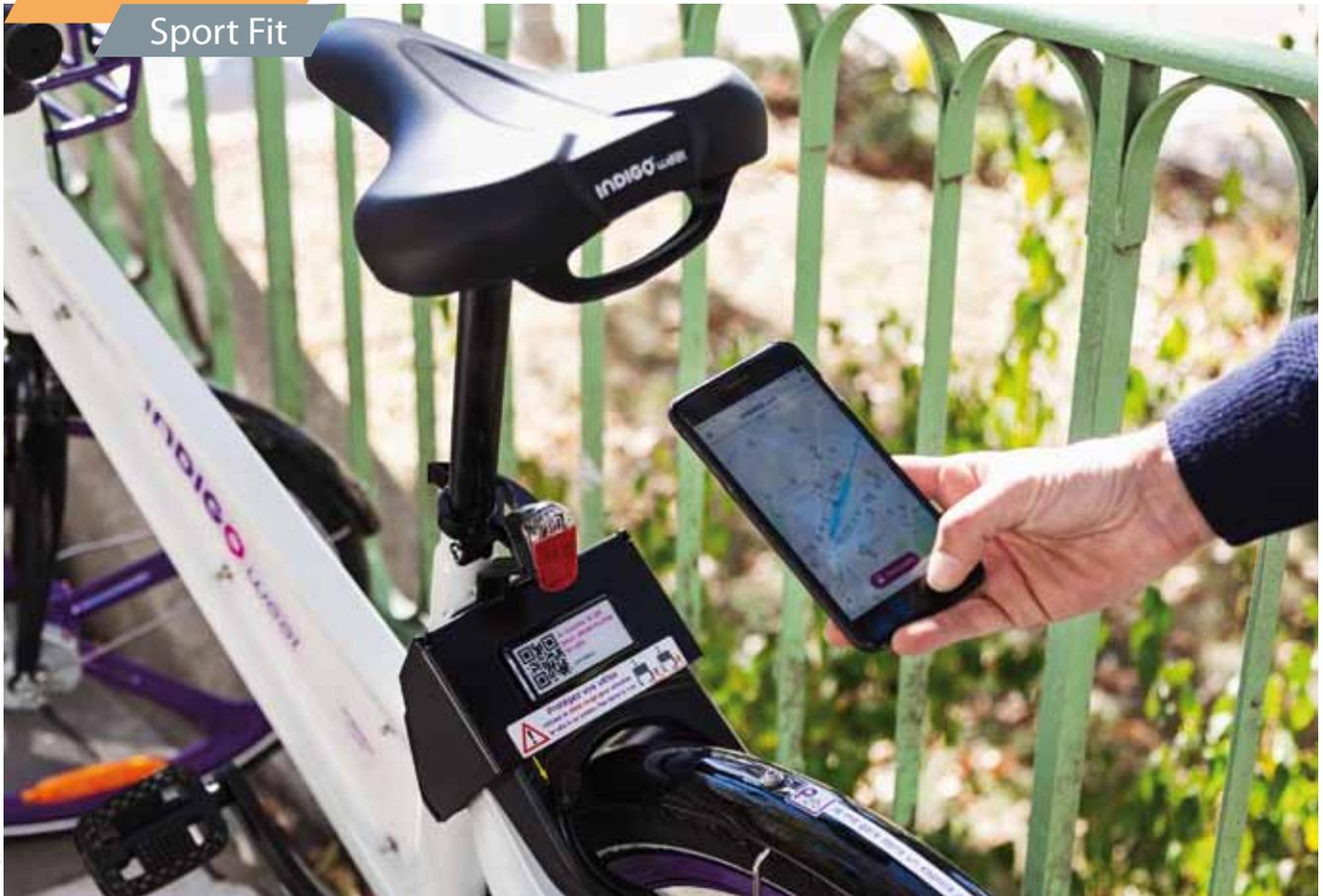
Les vélos sont géolocalisables grâce à l'application INDIGO® weel et les cadenas se déverrouillent à l'aide d'un QR code
